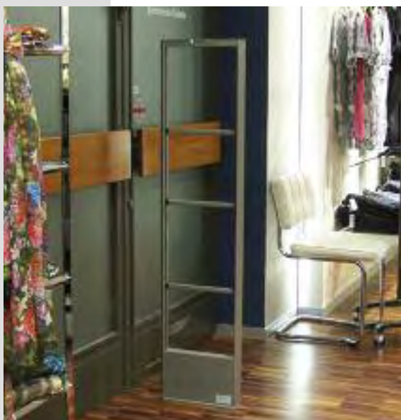
Typische Mono-Anwendung: nur eine Antenne deckt zwei Segmente ab
